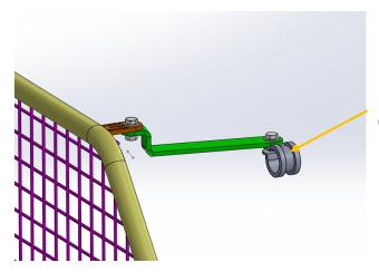
Fixer la poignée et la patte de fixation a l'aide de l'attache poignée.
