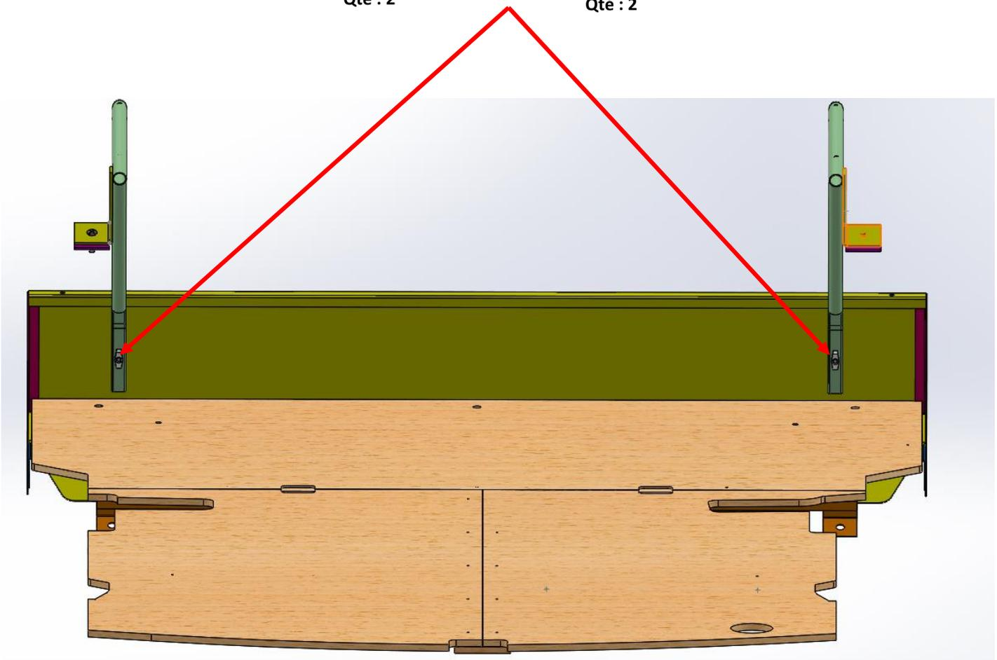
5) Fixer les arceaux sur les supports accroche dossier a l'aide de 2 vis poêliers M6 x 25 et 2 écrous cévennes M6 et de la platine REF: F2463
