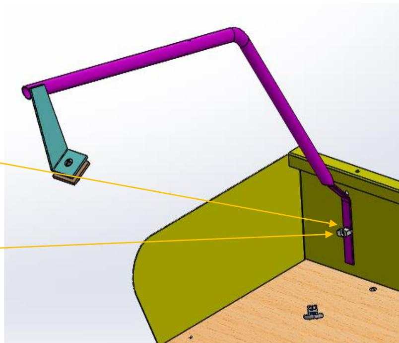
5) Fixer les arceaux sur les supports accroche dossier a l'aide de 2 vis poêliers M6 x 30 et 2 écrous cévennes M6 et de la platine réf F2323
