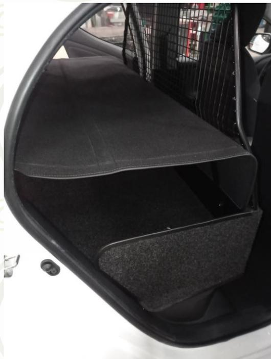
7) Contre-percer le couvre bagages et le fixer avec 2 vis Japy M5 et 2 écrous cévennes M5
