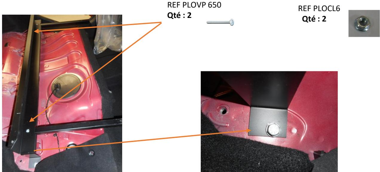
B ) Mettre les clips écrou sur les 2 pattes et mettre la tôle Réf TO1239 dans les encoches
