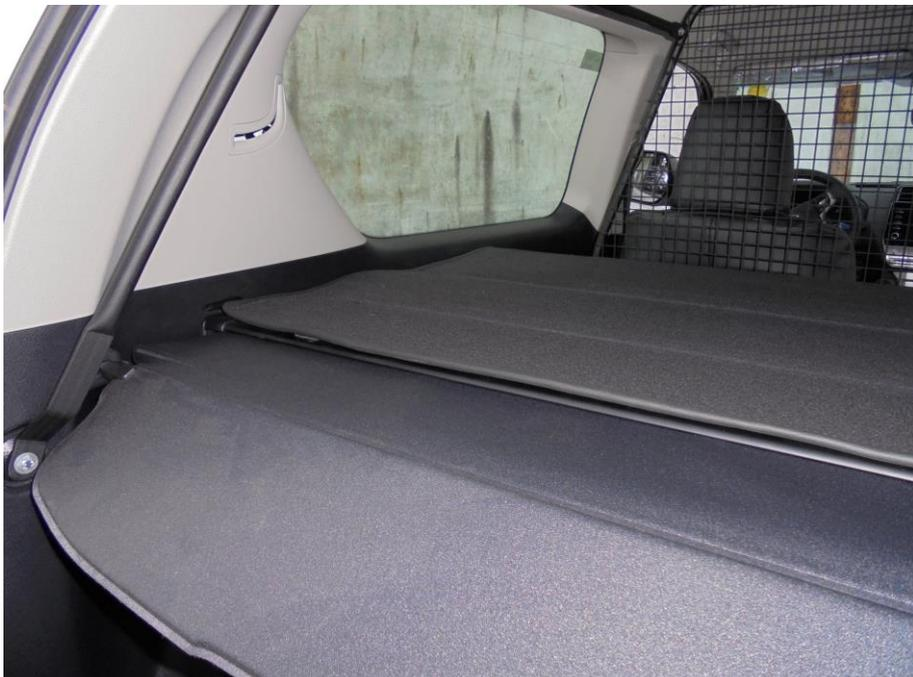
**7)** Contre-percer le couvre bagages. Fixer le avec 2 vis Japy M5 et 2 écrous cévennes M5
