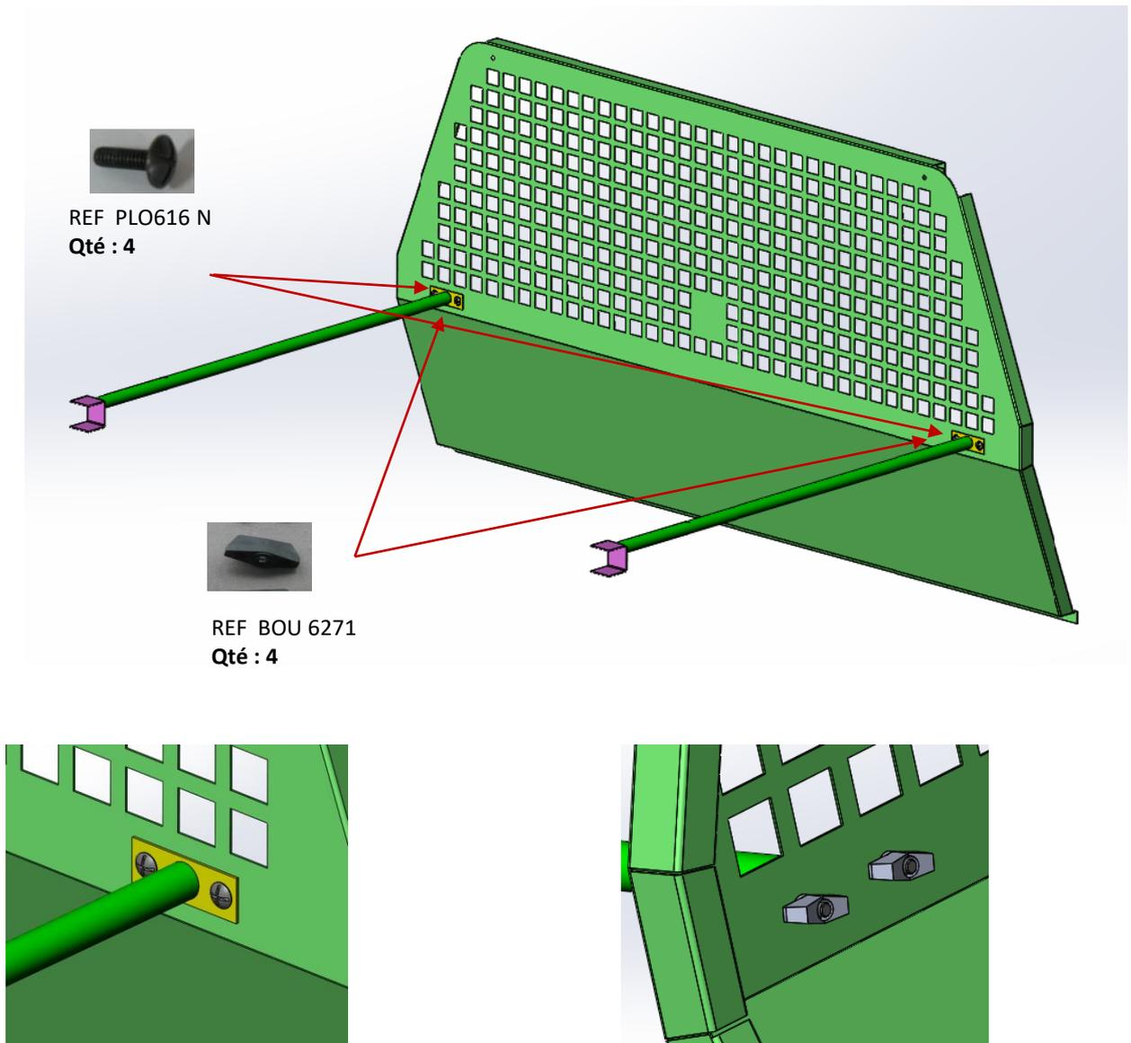
5) Installer la barre plage arrière enrouleur d'origine du véhicule et positionner les étriers dans la barre plage arrière.
