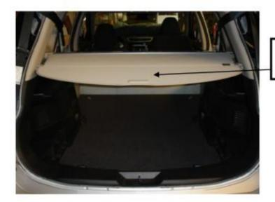
POSITIONNER LE ROULEAU D'ORIGINE POUR FIXATION ULTERIEUR DU COUVRE BAGAGE
