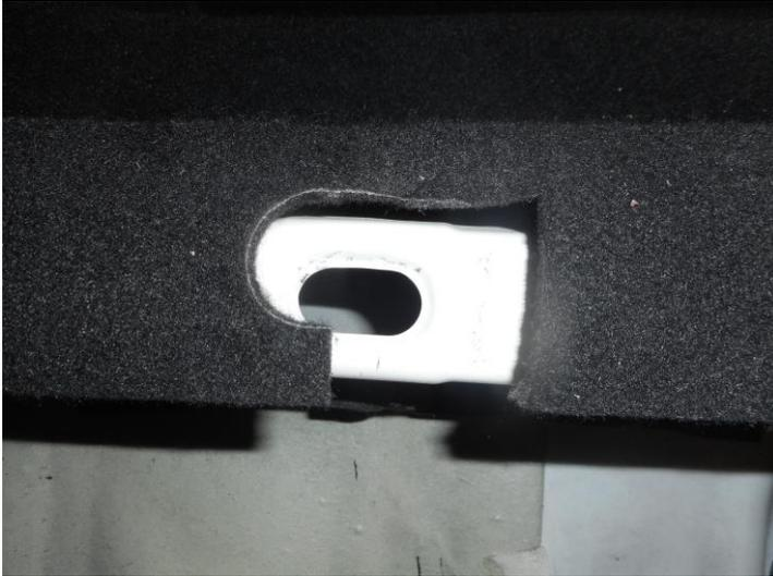
6) Placer les plaques TO0428 en dessous du trou oblong et fixer la traverse avant TO0422 ( ceci avec 2 vis hexagonale M8x20 et 2 rondelles M8 )
