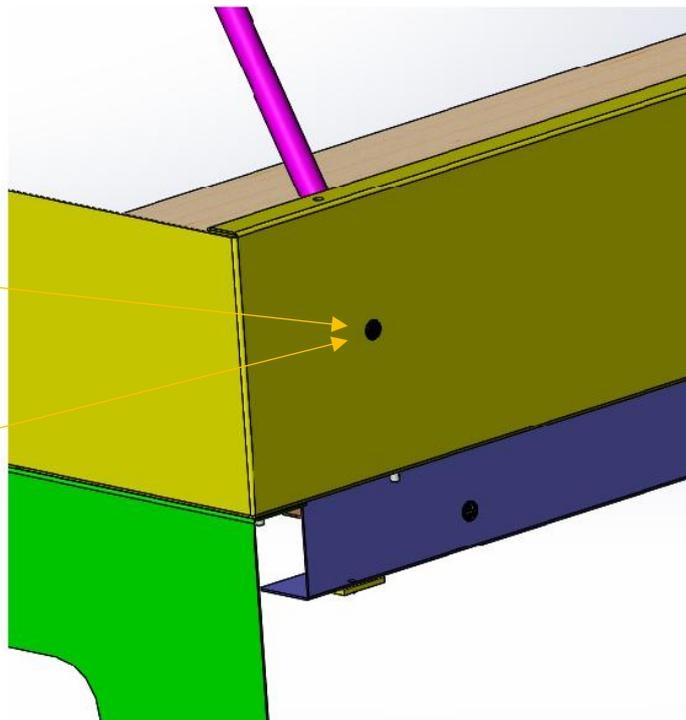
**5) Fixer les arceaux sur les supports accroche dossier à l'aide de 2 vis poêliers M6 x 30 et 2 écrous cévennes M6 et de la platine réf F4167**
