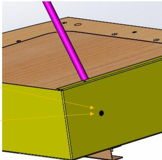
**5) Fixer les arceaux sur les supports accroche dossier à l'aide de 2 vis poêliers M6 x 30 et 2 écrous cévennes M6 et de la platine réf F3819**
