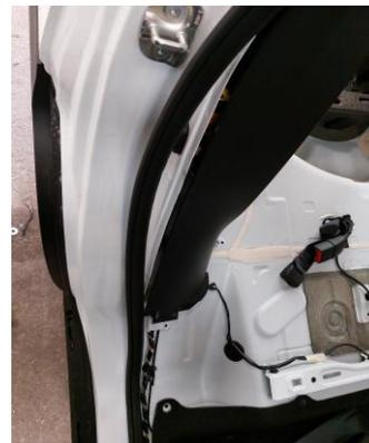
Puis, dans un deuxième temps, démonter le seuil du coffre arrière
