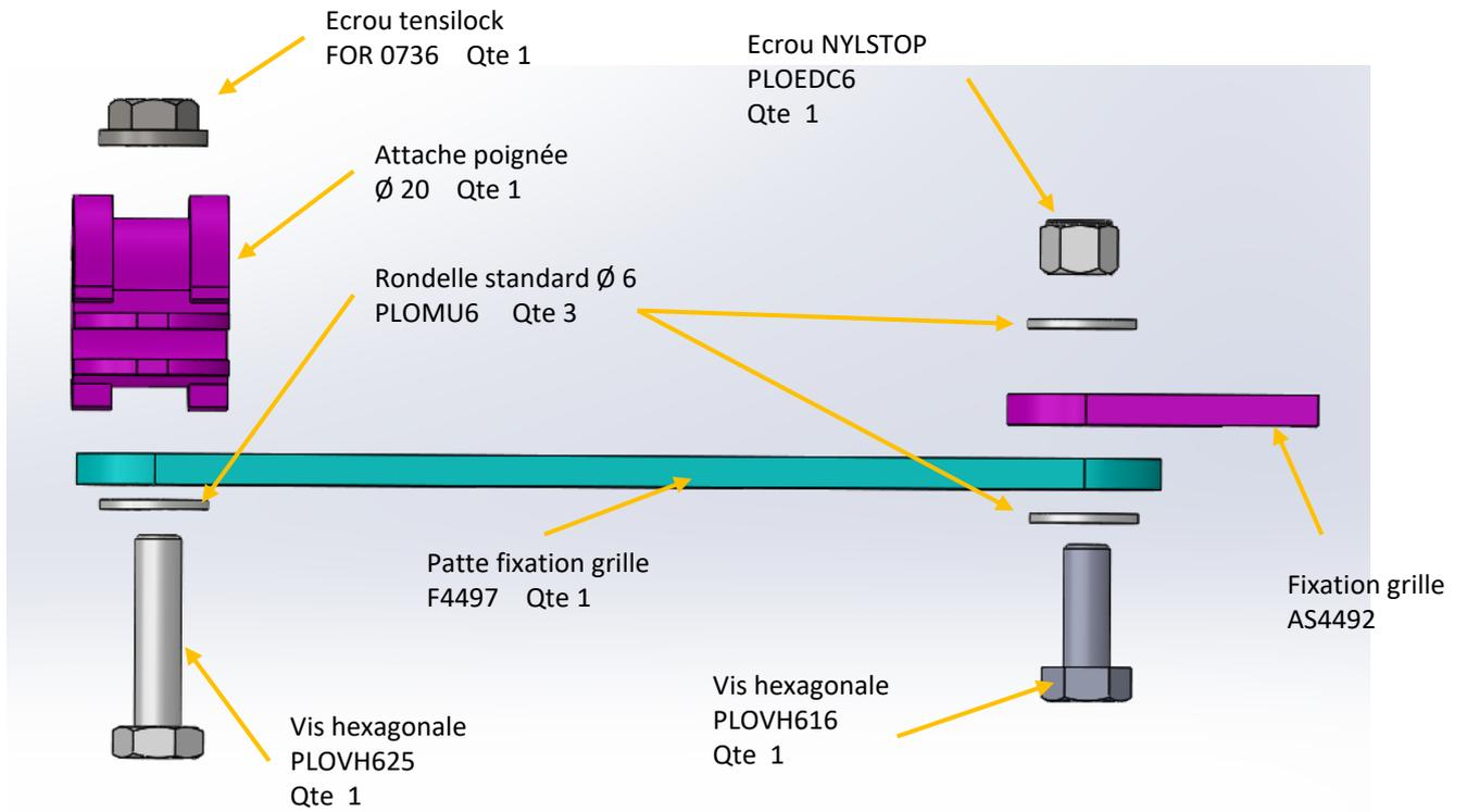
Fixer la poignée et la patte de fixation à l'aide de l'attache poignée.
