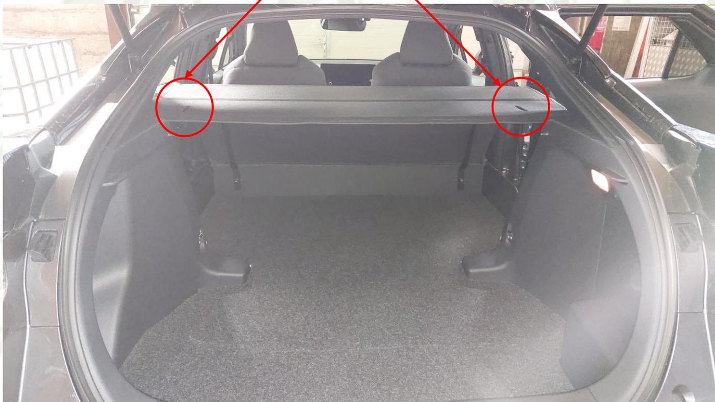
**5b) Fixation des arceaux droit et gauche TO2145 sur les ancrages de dossier de banquette arrière avec les arceaux couvre bagages .**
