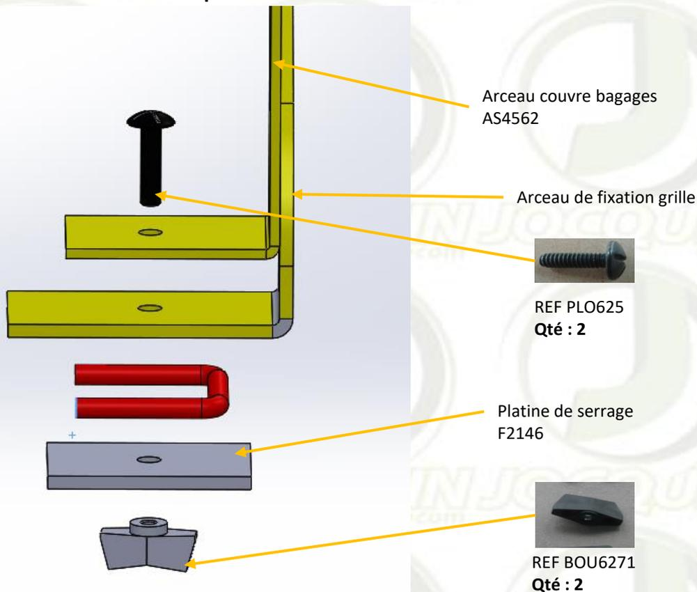
Etant donné que le véhicule est équipé d'un couvre bagage, il faut venir poser l'arceau couvre bagages AS4562 sur l'ancrage de dossier de banquette arrière et venir positionner au dessous de l'ancrage l'arceau de fixation grille et de fixer le tout à l'aide de 2 vis poêliers M6X25 et 2 écrous cévennes M6
