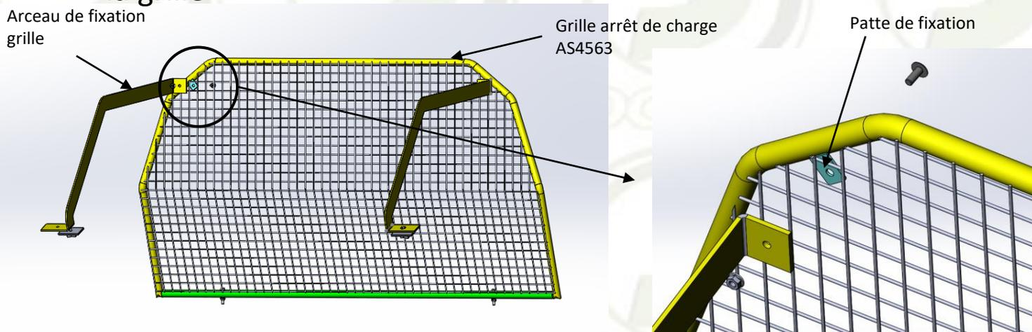
Les arceaux de fixation grilles sont à visser avec les pattes de fixation grâce aux 2 vis poêliers M6 x 16 et aux 2 écrous tensilock M6
