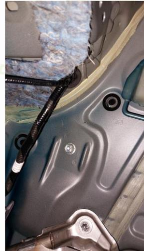
Dévisser la vis du point d'ancrage de l'ensemble de sangle de ceinture de sécurité et remettre en place la vis
