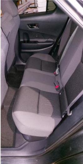
Déclipser, avec un outil en plastique spécifique à la dépose des garnitures de porte, l'assise sur le devant en tirant vers le haut
