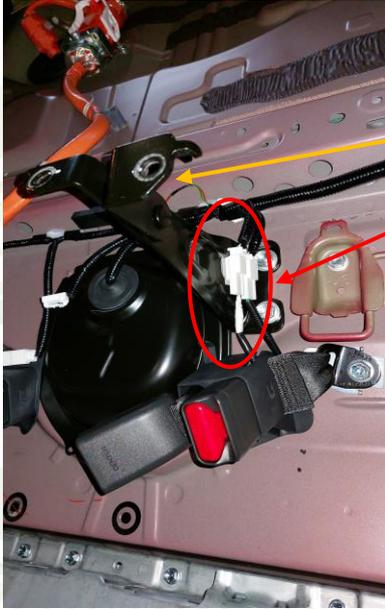
Désolidariser le connecteur du sous ensemble, puis dévisser les 2 vis tenant le sous ensemble. Et remettre en place les 2 vis ( Couple de serrage 36,8 Nm )
