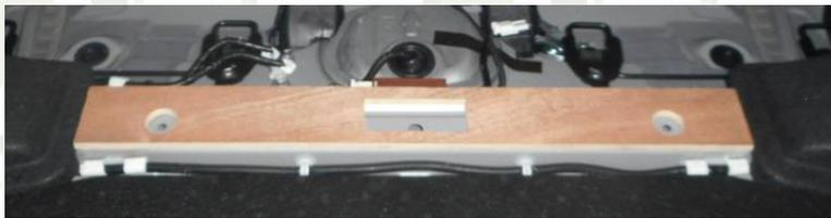
**15) Mise en place du plancher bois B0838 sur l'arrêt de charges S0822**
