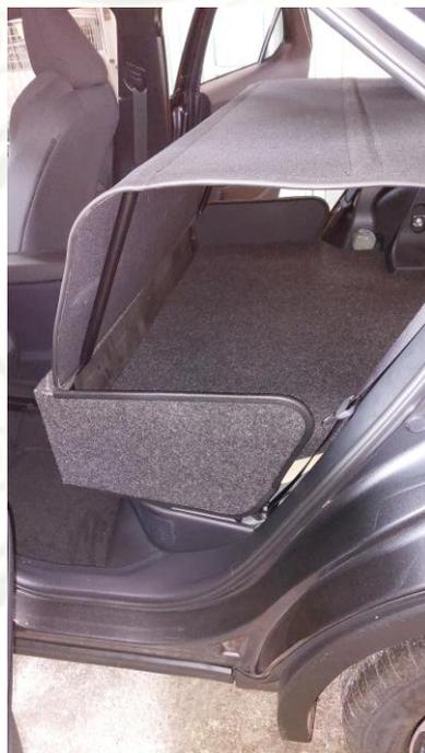
**7) Contre-percer le couvre bagages et le fixer avec 4 vis Japy M5 et 4 écrous cévennes M5**
