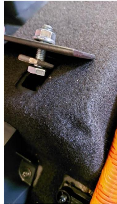
Puis visser l'écrou M8 en faisant un quart de tour a la plaque écrou, et mettre le bout du contre plaque écrou a 20mm du bord
