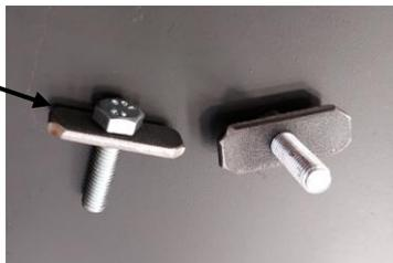
Dans un premier temps, mettre les vis hexagonale M8x30 PLOVH830 avec les plaques écrous F4388 et venir les visser bien à fond
