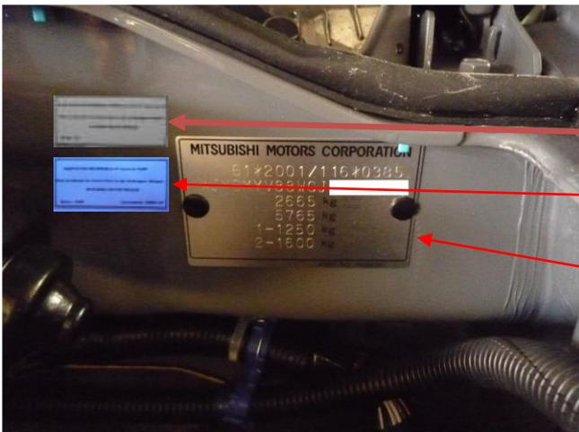
COLLER L'ETIQUETTE «ADAPTATION REVERSIBLE VASP EN VP » (RECUE AVEC LE DOSSIER DE RECONVERSION ) A COTE DES PLAQUE CONSTRUCTEUR ET TRANSFORMATION VASP. .
