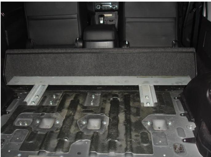
4 ) Déposer l'arrêt de charge .
