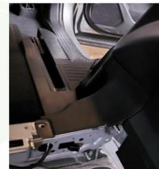
Remettre en place la plaque de finition de plancher arrière.
