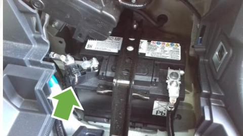
Débrancher le câble de la borne négative de la batterie
