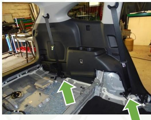
Dévisser les 4 vis des points d'ancrage de l'ensemble de sangle de ceinture de sécurité et remettre en place les vis ( **Couple de serrage 42 Nm** )
