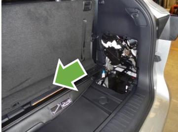
Déposer le cache d'orifice de batterie
