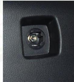
**Phase j4)** Déposer le crochet d'habillage de compartiment à bagages et dévisser la vis
