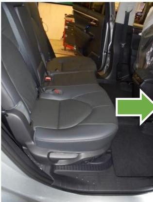
Pour faciliter le démontage des sièges arrière 2ème rangée, avancer les sièges arrière 1<sup>er</sup> rangée au maximum derrière les sièges avant.
