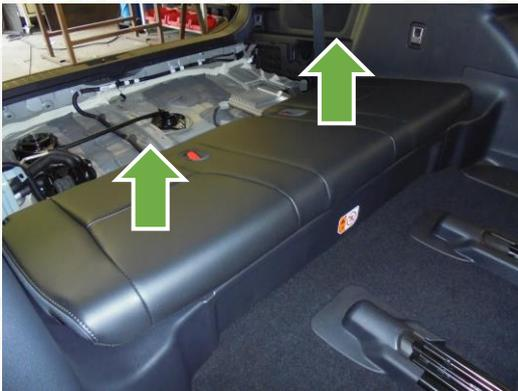
Soulever le bord avant de l'ensemble d'assise de siège arrière comme indiqué pour libérer les crochets d'armature d'assise de siège, puis déposer l'ensemble d'assise de siège arrière.
