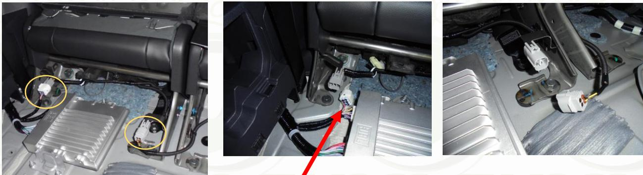
Puis protéger le connecteur du véhicule avec de la moquette et un rilsan, le fixer à l'aide d'un rilsan sur la connectique.
