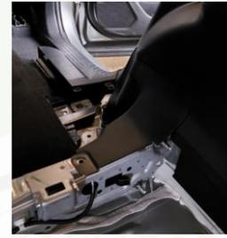
Remettre en place les caches d'habillage sous assise de siège arrière.
