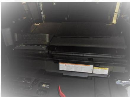
Dévisser la vis tenant le caisson de plancher du coffre arrière, puis le déposer
