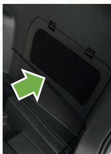
Puis remettre en place le cache d'orifice de batterie
