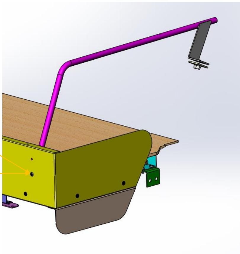
**5) Fixer les arceaux sur les supports accroche dossier à l'aide de 2 vis poêliers M6 x 25, 2 écrous cévennes M6 et de la platine réf TO2251**
