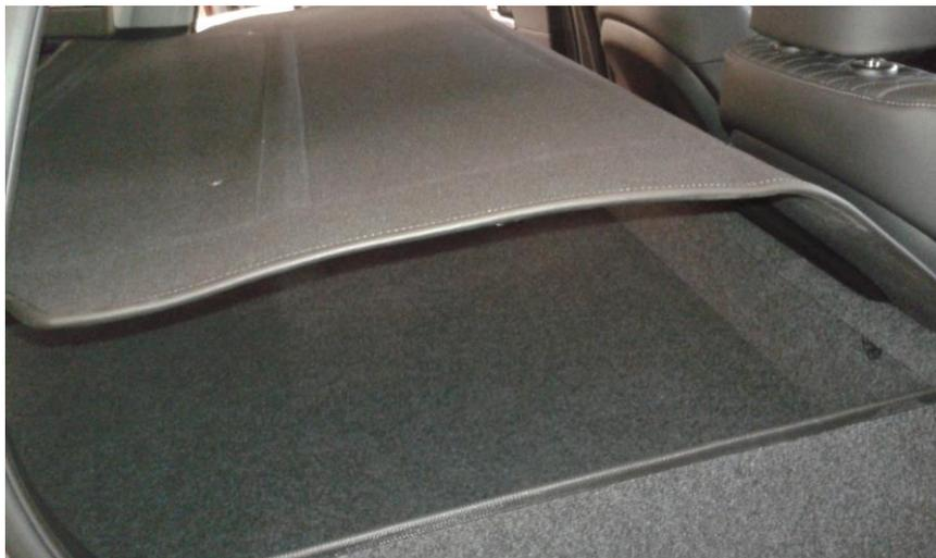
**7) Contre-percer le couvre bagages. Fixer le avec 4 vis Japy M5 et 4 écrous cévennes M5**
