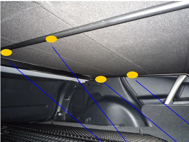
Contre percer les 4 trous de la tablette en Ø5, se servir des trous déjà percés dans le tube puis insérer 4 vis Japy M5 x 40 + bouton Cévennes.
