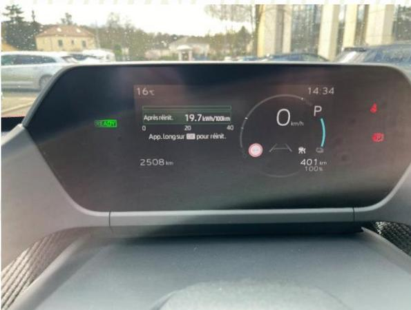
2 A l'aide de la commande au volant gauche, appuyer sur la flèche du bas afin de sélectionner le menu réglage « roue dentée »
