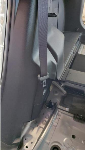
Déclipser la protection fixation du point d'ancrage de la sangle de sécurité
