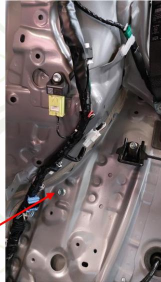
Dévisser la vis du point d'ancrage de l'ensemble de sangle de ceinture de sécurité et remettre en place la vis ( Couple de serrage 42 Nm)
