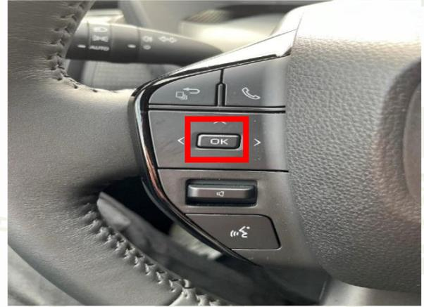
Ensuite sur le paramètre « Rappel siège arr. », appuyer une fois sur la touche « OK » de la commande au volant gauche pour activer ou désactiver la fonction
