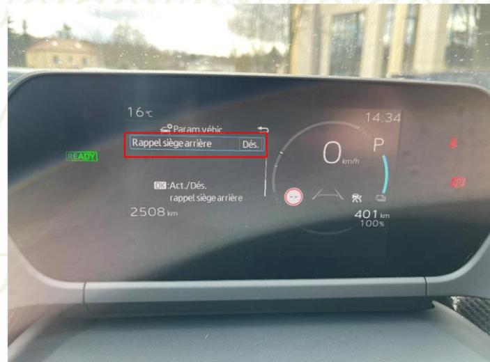
Les capteurs de présence de sièges arrière sont maintenant désactivés.
