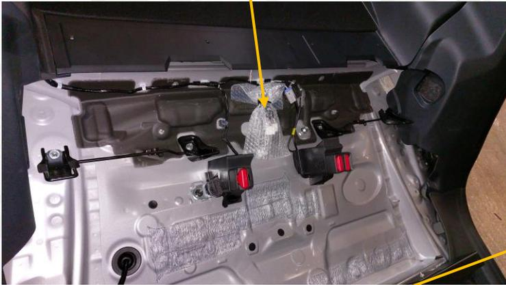
Protection des connecteurs à l'aide de moquette autocollante
