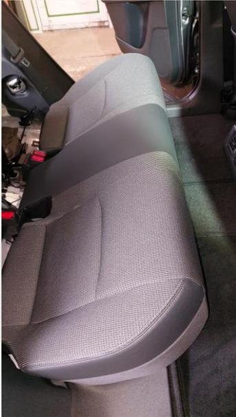
Déclipser, avec un outil en plastique spécifique à la dépose des garnitures de porte, l'assise sur le devant en tirant vers le haut
