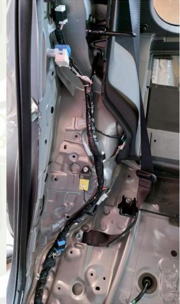
**i) Démontage de la plaque de finition de plancher arrière**
