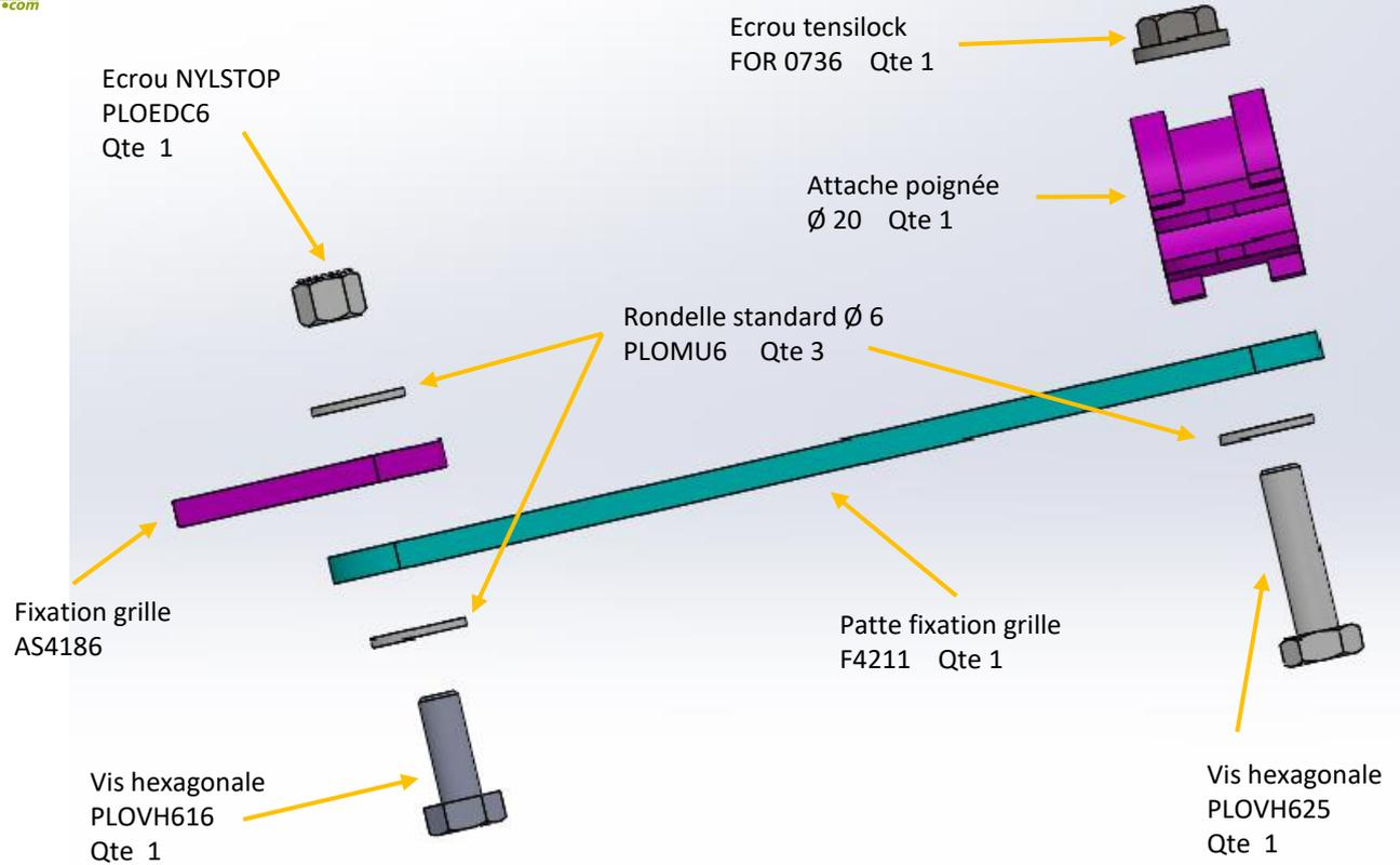
Fixer la poignée et la patte de fixation à l'aide de l'attache poignée.
