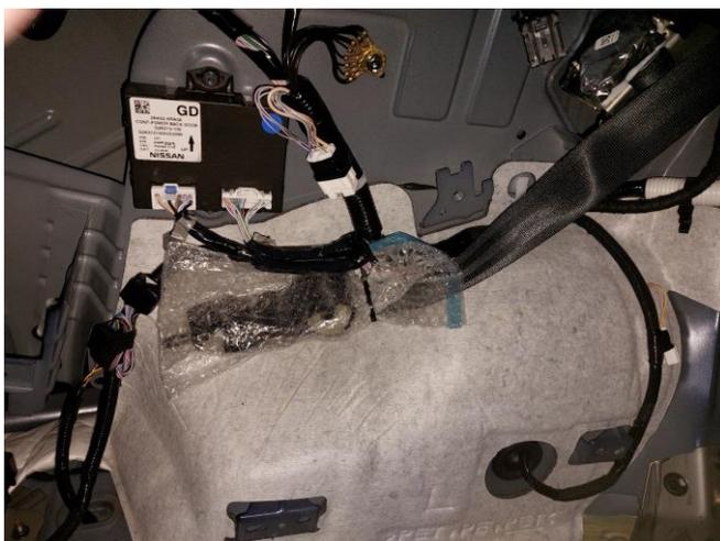
Conditionner les câbles d'alimentation des sièges arrière et mettre 2 pastilles autocollantes pour obturer 2 trous
