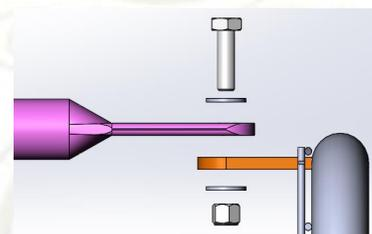
**5b) Fixation des ensembles arceaux droit et gauche TU4039 sur les ancrages de dossier de banquette arrière et avec les arceaux couvre bagages.**
