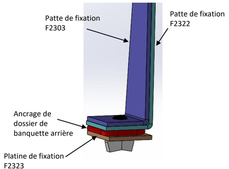
PS : Les platines F2323 ainsi que les 2 vis poêliers et les 2 écrous cévennes, reçu avec le kit grille ne seront pas utilisés. Etant donné que nous reprenons ceux déjà montés avec le couvre bagage.
