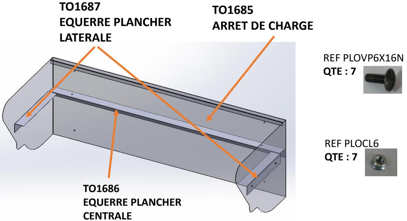
**f) Fixer l'arrêt de charge sur les longerons et sur les pattes inférieures**
