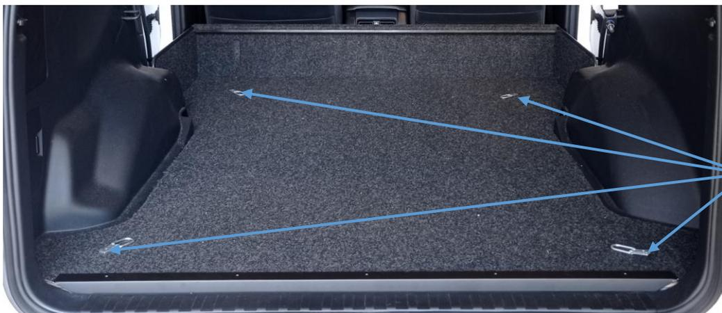
Fixation des 4 anneaux d'arrimage avec 4 vis poêlier M6x16
