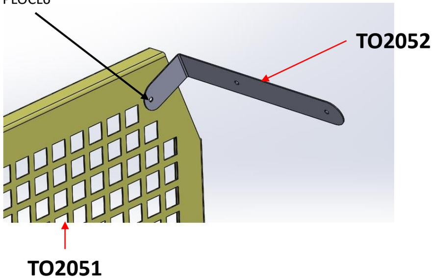
Puis fixer les pattes réf TO2052 , en utilisant les vis d'origine ,
