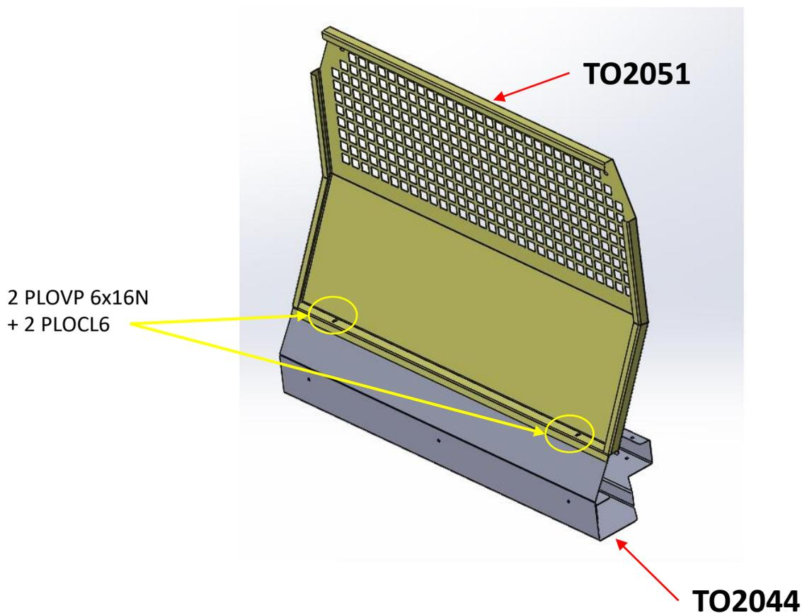
Positionner et fixer sur la grille a l'aide de 2 vis PLOVP 6x16N
