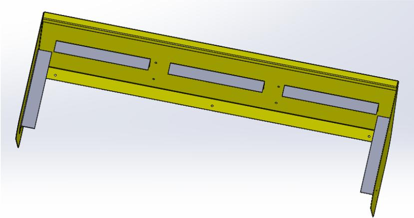
6) Mise en place des Ass fixation arrêt de charges 12-SUXV-S-40 sur le socle fixation arrêt de charges TO0466 a l'aide de 4 vis poêlier PLOVP616 N et 4 écrous tensilock FOR 0736
