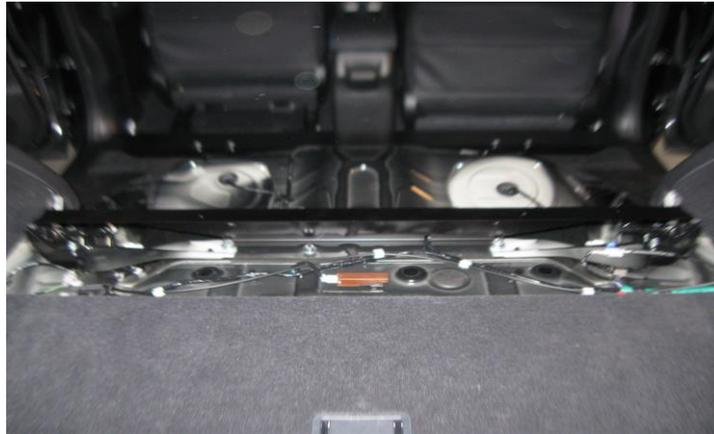
8) Montage des 3 écrous cage FOR791 sur le socle fixation arrêt de charges TO0466
