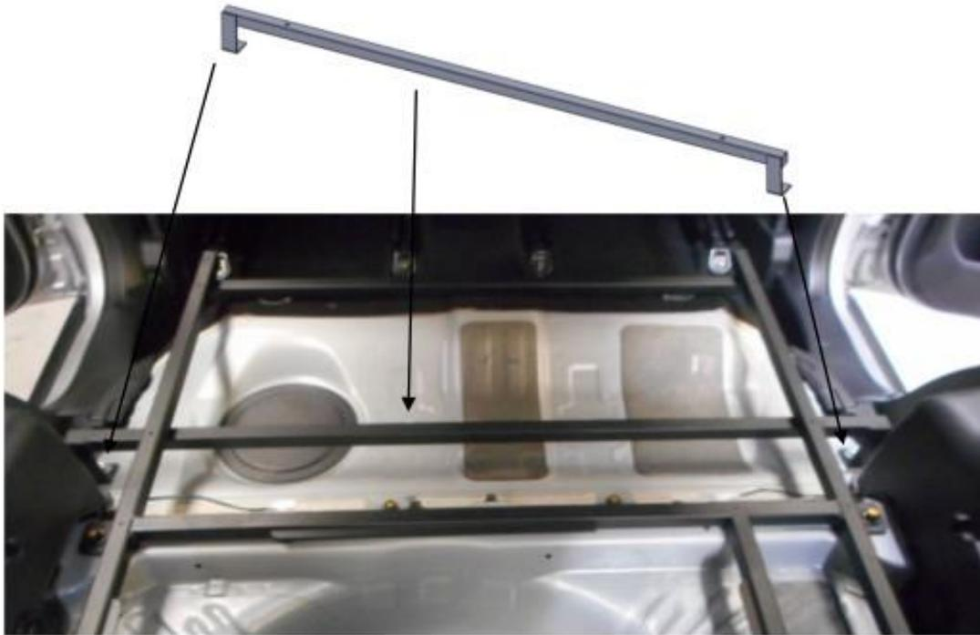
3 ) Fixer la structure principale avec les fixations d'origine du véhicule et les vis tête hexagonale Lg 40.
