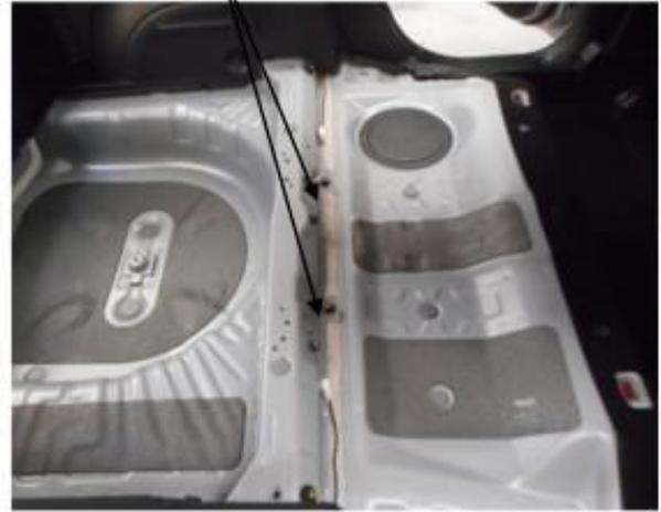
ATTENTION : POUR LE CONDITIONNEMENT DES CEINTURES AR IL EST IMPERATIF DE LAISSER 1 M DE GARDE AU NIVEAU DE LA BOUCLE POUR EVITER LE BLOC GE DEFINITIF DU SYST ME D'ENROULEUR
