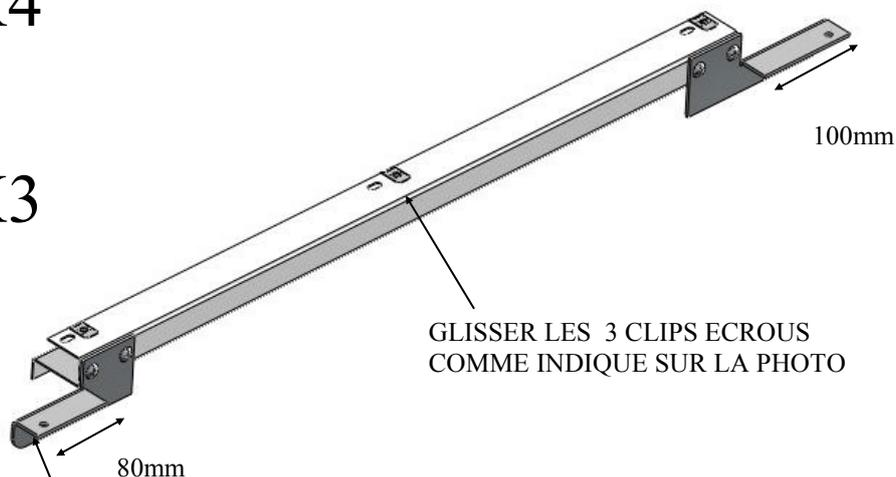
FIXER LES 2 SUPPORTS AVEC 4 VIS POLIER M6 LG 10 + EROUS TENSILOCK
