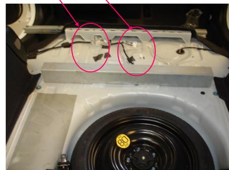
**REMONTER L'ENSEMBLE DES GARNITURES EN POSITIONNANT LES 4 MOUSSES 100 x 100 ep 40 COMME INDIQUE SUR PHOTO CI-DESSOUS.**
