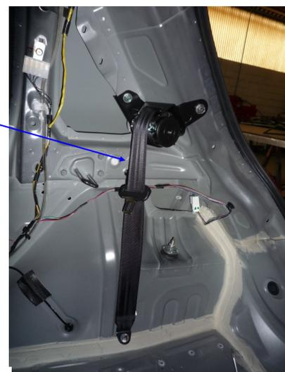
ATTENTION : POUR LE CONDITIONNEMENT DES CEINTURES AR IL EST IMPERATIF DE LAISSER 1M DE GARDE AU NIVEAU DE LA BOUCLE POUR EVITER LE BLOCAGE DEFINITIF DU SYSTEME D'ENROULEUR.
