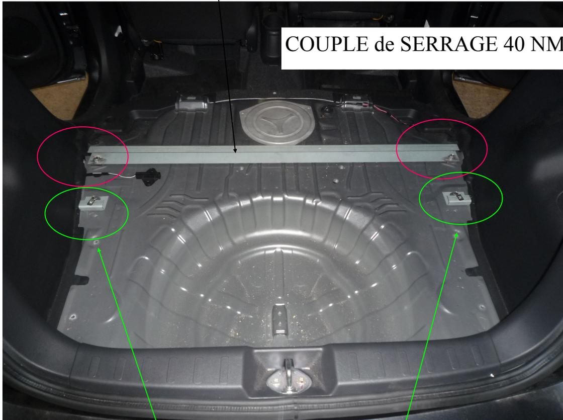
POSITIONNER 2 SUPPORT LATéraux PUIS FIXER LES AVEC 2 VIS M10
