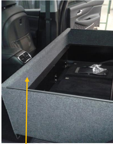
Arrêt de charges partie haute TO2272
