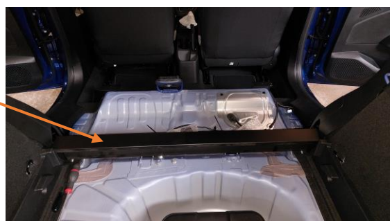
Traverse centrale TO2879
