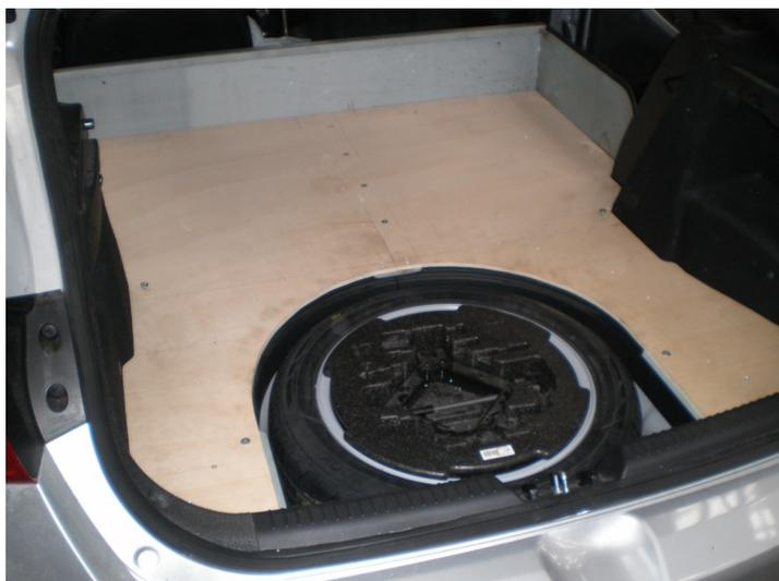
NE PAS FIXER LA TRAPPE ROUE de SECOURS POUR AVOIR ACCES A LA ROUE .
