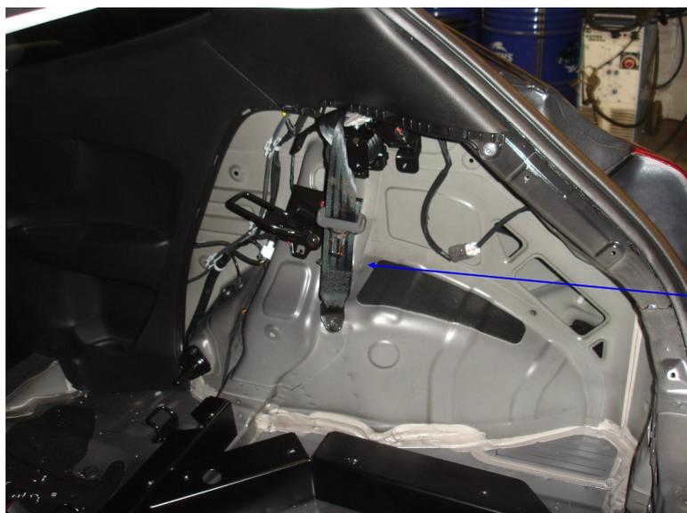
**ATTENTION : POUR LES CEINTURES ARRIERES IL EST IMPERATIF DE LAISSER 1M de SORTIE AU NIVEAU DE LA BOUCLE SINON BLOQUAGE POSSIBLE DEFINITIF DE LA CEINTURE.**
