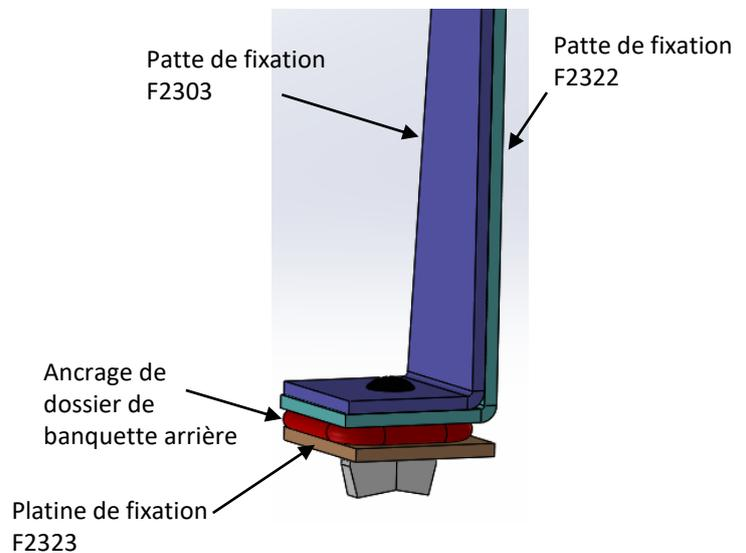
PS : Les platines F2323 ainsi que les 2 vis poêliers M6x30 et les 2 écrous cévennes, reçu avec le kit grille ne seront pas utilisés. Etant donné que nous reprenons ceux déjà montés avec le couvre bagage.
