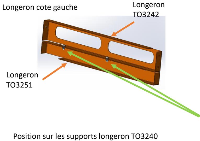
Assemblage des longerons TO3242 et TO3251 a l'aide de 2 vis hexagonales , 2 rondelles Ø6 et 2 écrous tensilock M6 Répéter ceci pour les longerons cote droit
