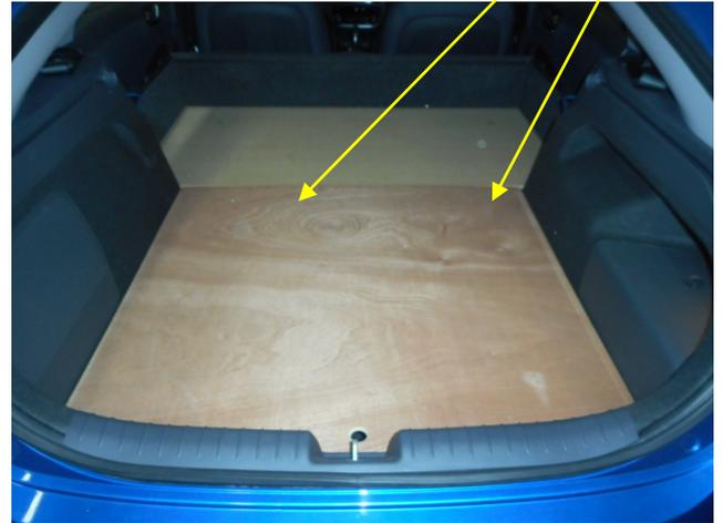
**g) Fixer la trappe coté droit B1207 avec la cale trappe B1208 sur le plancher arrière.**
