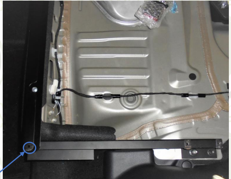
Visser les vis PLOVP et écrous PLOCL6 aux 2 extrémités de la traverse
